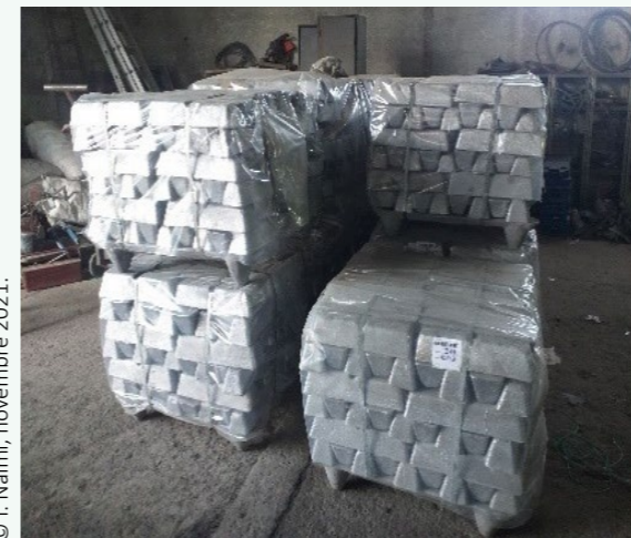
Lingots d'aluminium fabriqués à partir de la ferraille.
