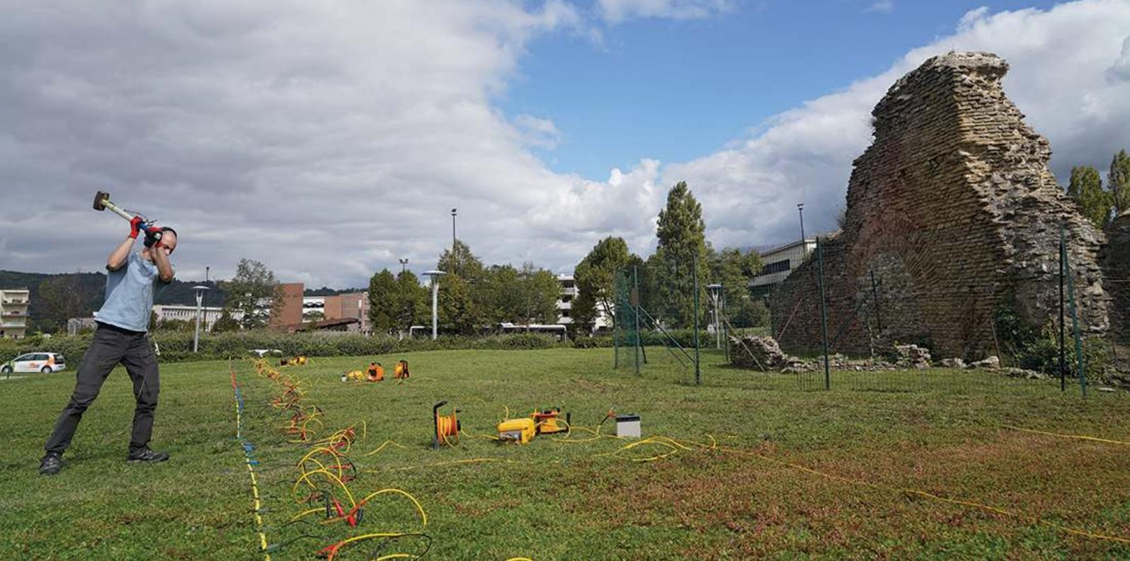
Prospection sismique sur le secteur occidental du Palais du Miroir. Les ondes sismiques sont générées manuellement par une masse qui frappe une plaque métallique posée sur le sol © Christophe Benech
